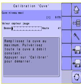
Une fois le calibrage du capteur de jauge réalisé, procéder au calibrage de cuve (<u>calibrage</u> <u>de la cuve</u>)
