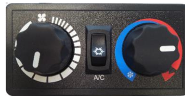
Ventilation et contrôle du chaud par la vanne de chauffage.
