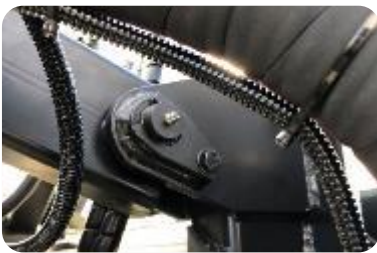
8 Articulations gauche du relevage de rampes sur le cadre de rampes.
