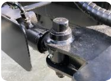
12 Vérins d'ouverture de rampes.
