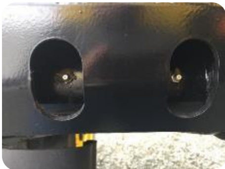
4 Articulation essieu arrière gauche
