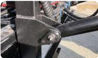
8 Articulations gauche du relevage de rampes sur le cadre de rampes.
