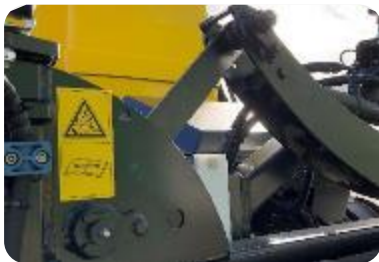
12 Vérins d'ouverture de rampes.
