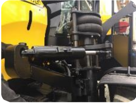
1 Vérin de direction avant gauche.
