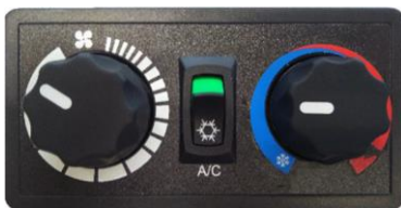
Le bouton A/C est sur ON , le compresseur se met en fonctionnement Le contrôle de la température se fait par la vanne de chauffage. Position désembuage.
