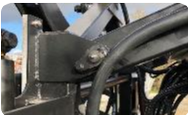
9 Articulations droites du relevage de rampes sur le cadre de rampes.
