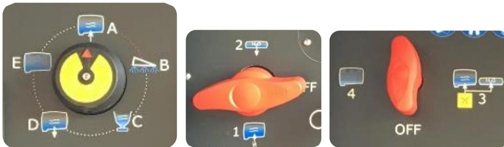
Lors d'un remplissage programmé via le boîtier « **TANKMATIC** », celui-ci ne tient pas compte du remplissage de la cuve de rinçage, ce sera à l'opérateur de tourner la vanne de sélection en position neutre une fois le remplissage de la cuve de rinçage terminée.
