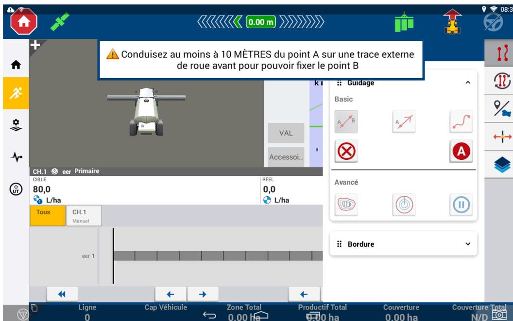
Avant de pouvoir créer une ligne et définir un point B, il est nécessaire d'effectuer une distance d'au moins 10m depuis le point de départ (point A).
