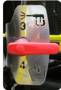
Lors d'un remplissage programmé via le boîtier « TANK MATIC », celui-ci ne tiens pas compte du remplissage de la cuve de rinçage, ce sera à l'opérateur de tourner la vanne de sélection en position neutre une fois le remplissage de la cuve de rinçage terminée.
