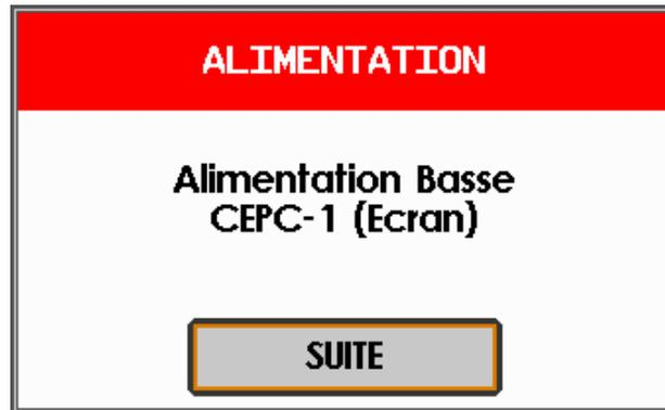
L'appui sur la touche « SUITE » ou « FERMER » permet d'acquieser le défaut affiché et de stopper le buzzer. Il permet de plus le retour sur la page en cours ou l'accès au défaut suivant. Le défaut sera alors réaffiché à sa prochaine apparition ou sur demande de visualisation.
