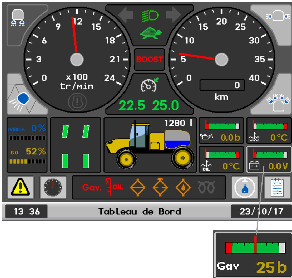
Un appui sur la jauge avec un contour blanc permet d'afficher différentes information.
