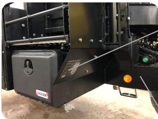
La plaque de firme (1), indiquant l'identité de l'automoteur est fixée à la droite de la cabine.
