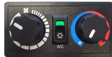
Le bouton A/C est sur **ON**, le compresseur se met en fonctionnement
