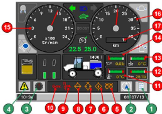
Les contrôles permanents de la pression d'huile moteur (Rep.14), de la température d'eau (Rep.13), de la température d'huile hydraulique (Rep.11) et de la pression de gavage (Rep.12) se font sur les cadrans liés à ces fonctions sur la page de travail.
