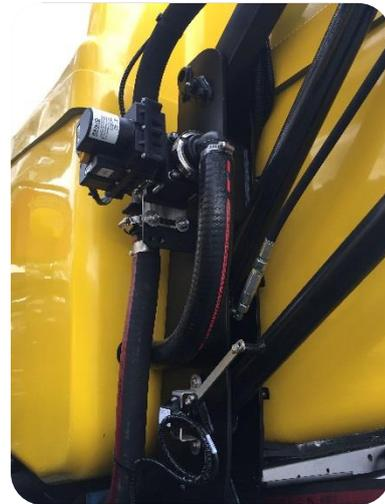
6 Articulations droites du relevage de rampes sur le châssis
