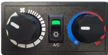
Le bouton A/C est sur **ON**, le compresseur se met en fonctionnement
