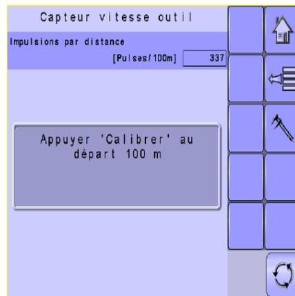
Avant de procéder au calibrage de la vitesse, mesurer précisément une distance de 100m, délimitée par des jalons, idéalement sur terrain meuble.
