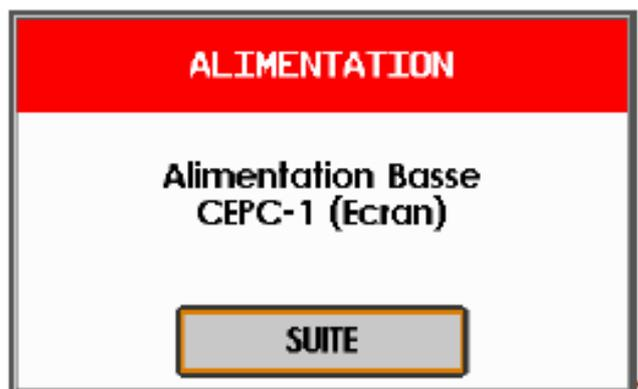
L'appui sur la touche « SUITE » ou « FERMER » permet d'acquitter le défaut affiché et de stopper le buzzer. Il permet de plus le retour sur la page en cours ou l'accès au défaut suivant. Le défaut sera alors réaffiché à sa prochaine apparition ou sur demande de visualisation.
