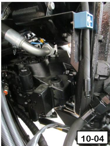
Le moteur DEUTZ entraîne en bout de vilebrequin côté volant une boîte de répartition ou de couplage sur laquelle sont disposées plusieurs pompes hydrauliques :
