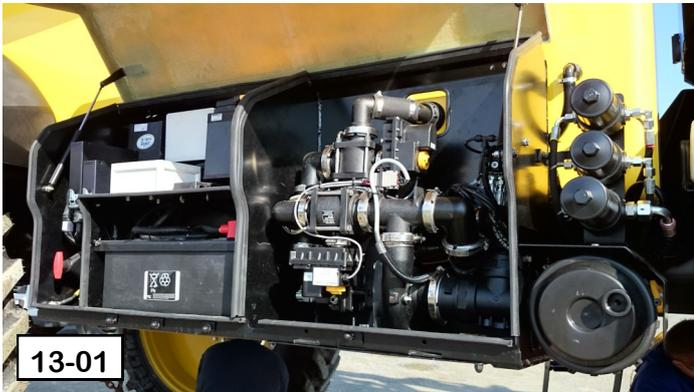
La batterie est placée dans un coffre avec carter côté droit du matériel entre l'essieu avant et l'essieu arrière. ( photo 13.01 )
