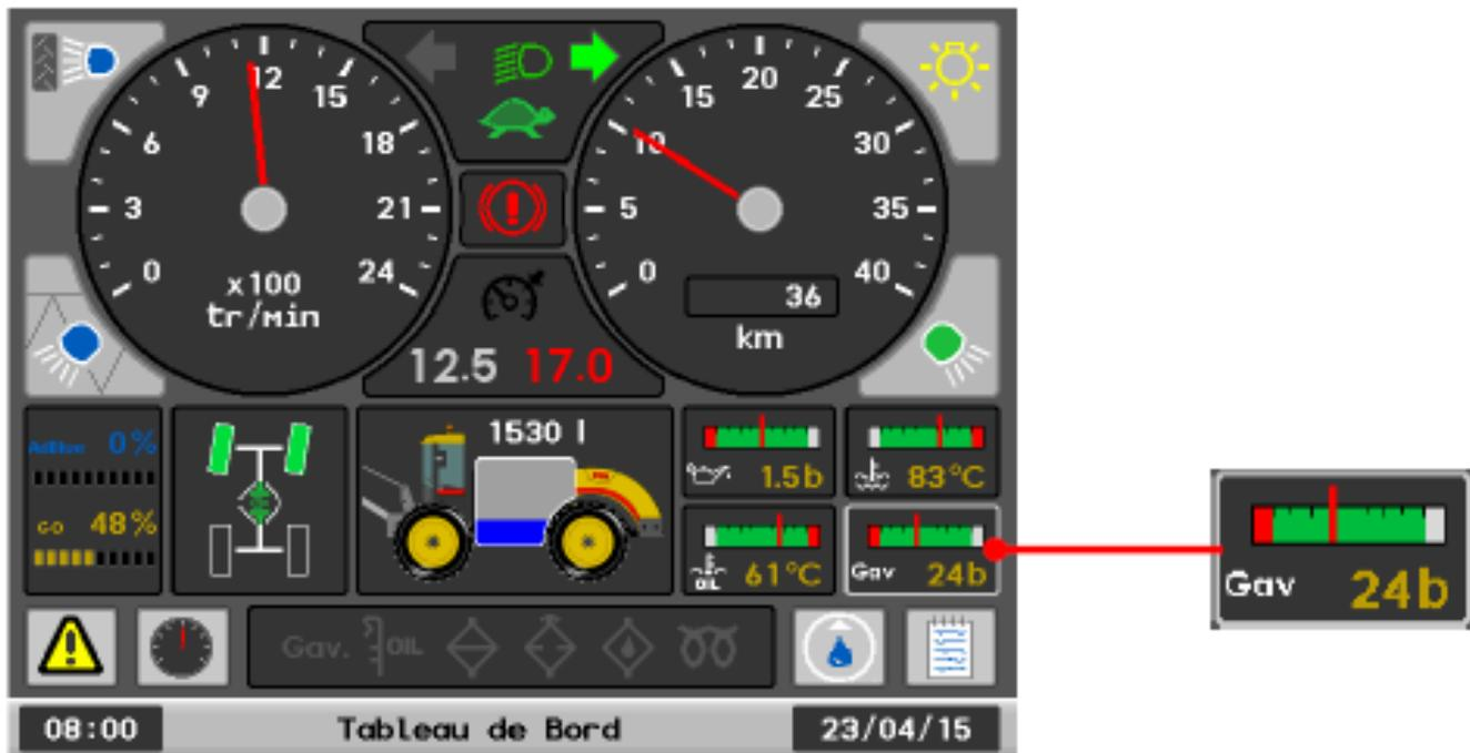
Un appui sur la jauge avec un contour blanc permet d'afficher différentes informations :
