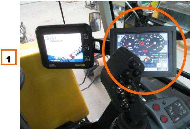
La page de route apparaît automatiquement si la pompe de pulvérisation n'est pas enclenchée et si le suivi des rampes n'est pas activé.
