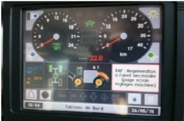
Lors de l'envoi de la demande de régénération de service par le calculateur moteur, un bip sonore est émis et le message « FAP : régénération à l'arrêt nécessaire » apparaît (voir image de gauche).
