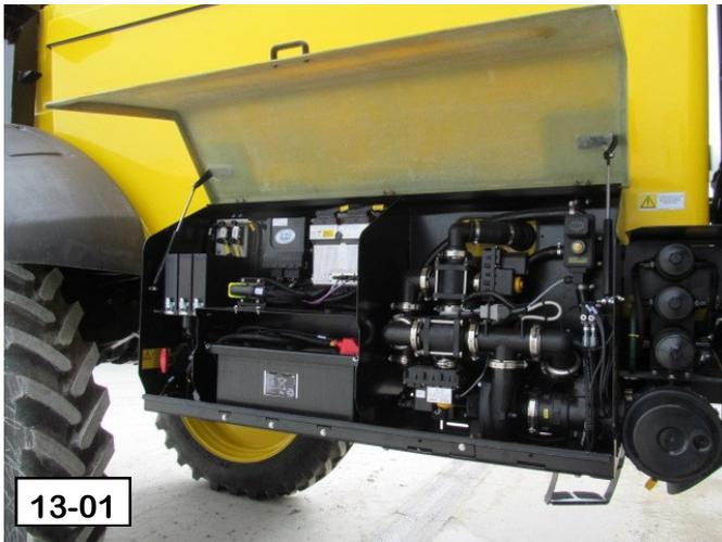
La batterie est placée dans un coffre avec carter côté droit du matériel entre l'essieu avant et l'essieu arrière. ( photo 13.01 )
