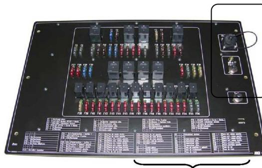
Dans cette zone sous la platine se trouvent les relais K211 et K212 avec fusibles 20A ( Feux de cabine )
