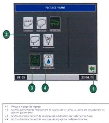
Dans le cas où la machine est équipée d'une vanne électrohydraulique, toutes les étapes de rinçage se réalisent depuis la cabine via cet affichage.
