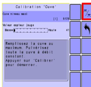
Une fois le calibrage du capteur de jauge réalisé, procéder au calibrage de cuve (*calibrage de la forme de la cuve*)
