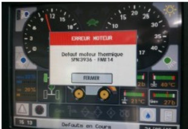
Après 50h au niveau précédent, le niveau de warning est activé. Les messages d'erreur SPN 3936 (passage au niveau de sévérité « Warning ») et SPN 524190 (réduction de puissance niveau 1) apparaissent à l'écran (voir image de gauche). Des bips sonores sont émis lors de l'apparition des erreurs.
